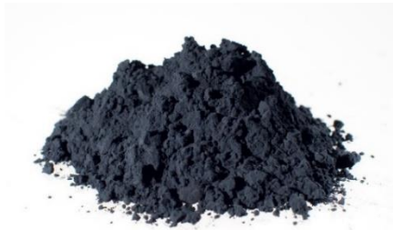
正極材料：ニッケル酸リチウム
