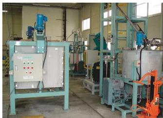
最新式の重金属高効率洗浄パイロット試験設備
