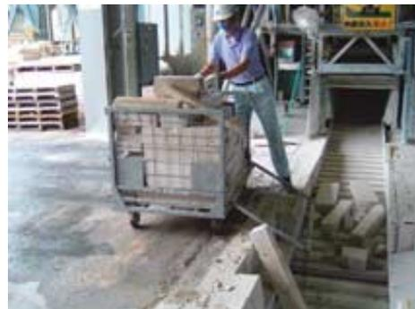
栃木工場における破碎工程への残材投入作業
