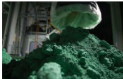
電池材料 高性能乾電池や、ハイブリッド型電気自動車用二次電池の正極材料として、水酸化ニッケルが使用されます。
