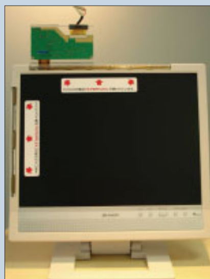
液晶テレビに使用される2層めっき基板 矢印の先に2層めっき基板が使用されています。
