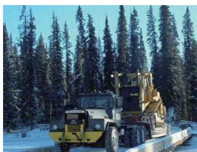
ウィンターロードを使用した重機搬送 最重量重機の搬送の際はうまく気温が下がり、十分な結氷が得られました
