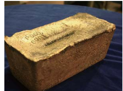
ファースト・ドーレ（最初に生産された金・銀の合金） ポゴ金鉱山では経済合理性を考慮し、金94%、銀6%のドーレまでを生産。99.99%の純金への精製はカナダの貴金属精製会社へ委託しています
