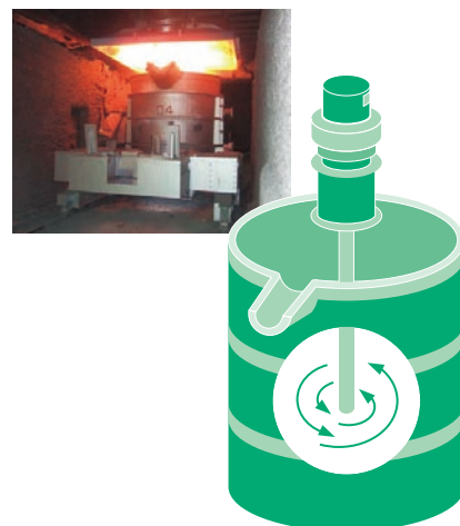
スターラー (機械攪拌装置)と仕組み(イラスト)
