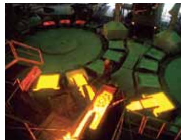
東予工場アノード製造機
