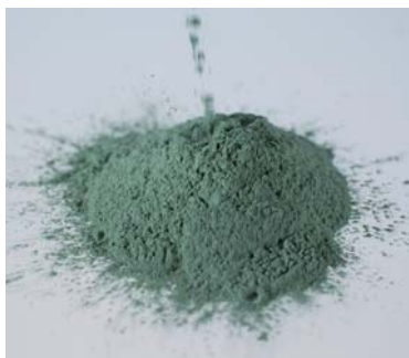
▲電池正極材の素材となるプリカーサ
