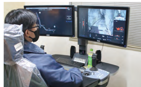
菱刈鉱山内重機の地上からの遠隔操作
