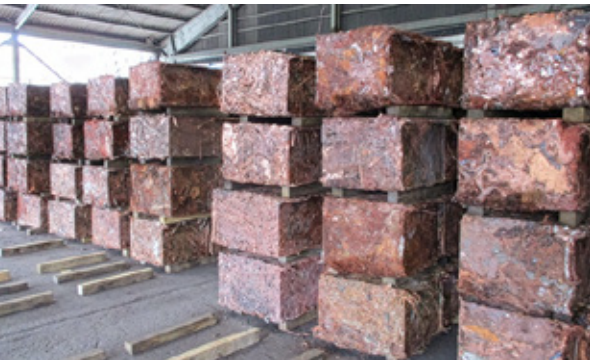
利用されるリサイクル原料（プレス加工後の銅スクラップ）
