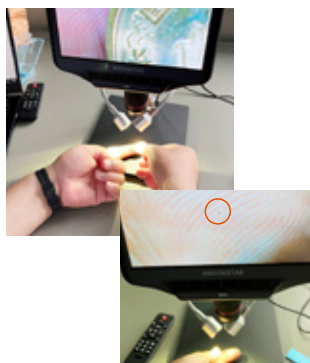
コインを指先に擦り付け、顕微鏡で確認すると指先に付着した銅微粉が確認できる
