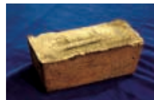
ポゴ金鉱山で精製された中間製品 （金品位約94%、銀品位約6%）
