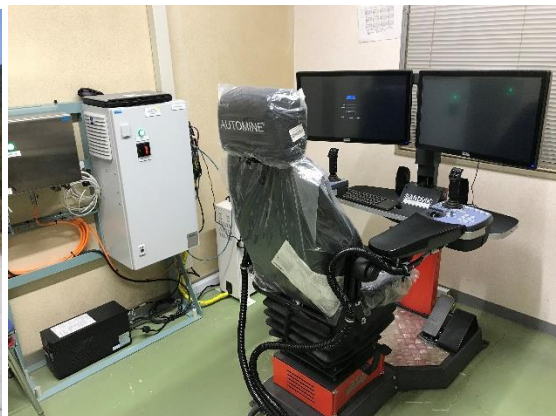
コントロール室内の AutoMine®操縦席の様子（地上からの遠隔操作）
