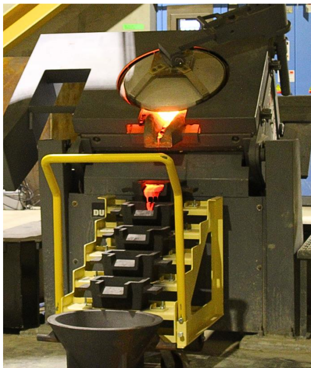
金ドーレの鑄込みの様子
